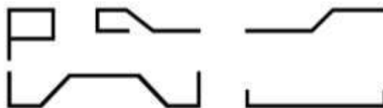
Рис. 5 Формы изгиба арматуры
